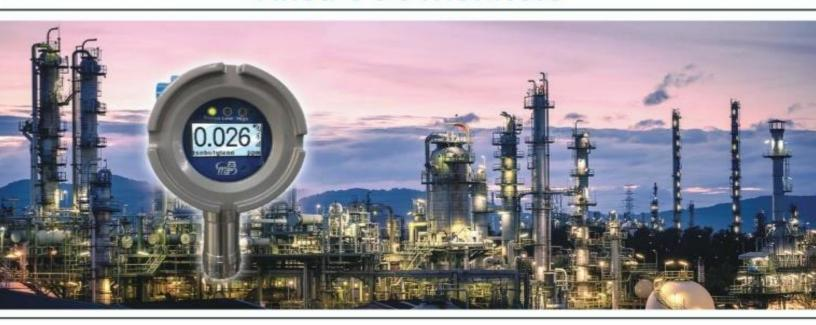
VOXI 시리즈는 광 이온화 검출(PID) 기술을 사용하여 MP812의 경우 1ppb, MP815의 경우 10ppb의 분해능에서 휘발성 유기 화합물(VOC)을 모니터링합니다. 내장형 히터는 습도가 높은 조건에서 트랜스미터의 수분 응결을 방지합니다. 혁신적인 자외선 (UV) 10.6 eV 램프 및 전위계 설계로 오염을 줄이고 보다 정확하고 안정적인 판독 값을 제공하고, 유지 보수 간격을 연장합니다. 모바일 앱과 Bluetooth 컨트롤러를 사용하면 현장 구성, 테스트 및 문제 해결을 쉽고 편리하게 수행 할 수 있습니다. OLED 디스플레이는 강한 조명 아래에서도 멀리서 볼 수 있으며, 데이터 및 경보는 무선 또는 케이블을 통해 컨트롤러로 지속적으로 전송됩니다.
